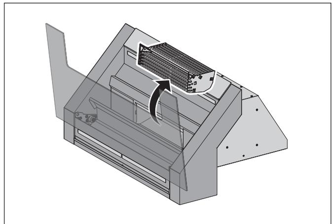
☞ Fassen Sie das Capillar Trap seitlich mit beiden Händen an.
