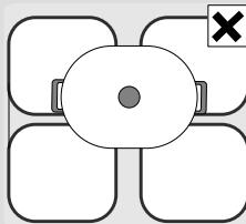
Устанавливайте посуду таким образом, чтобы каждый раз была покрыта только одна из комбинированных зон нагрева.
